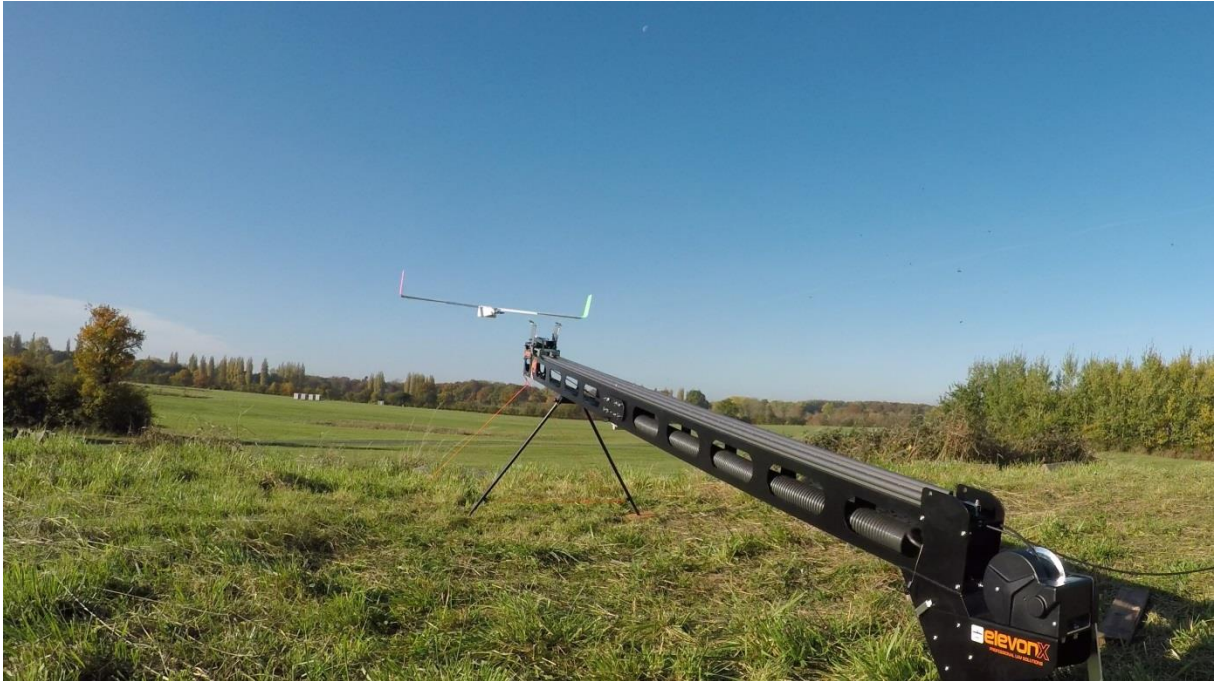
LUCA unmittelbar nach dem Verlassen des Startkatapults, Bildnachweis: H. Wickboldt / TU Braunschweig
