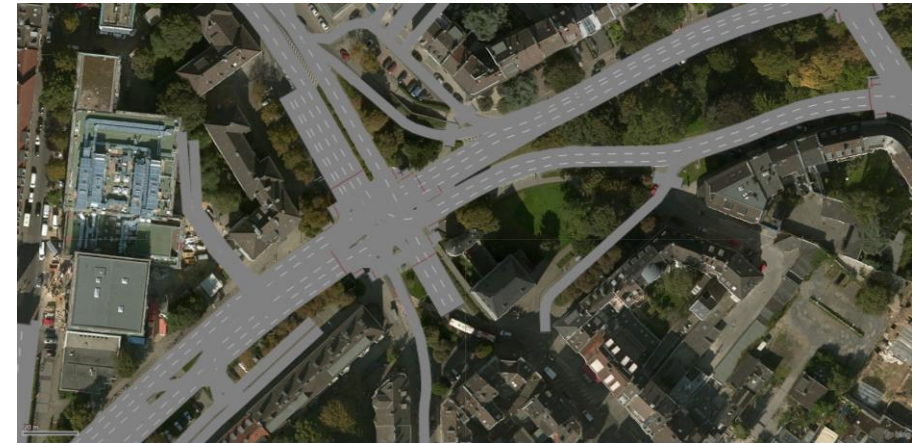
Beispielhafter Ausschnitt einer Verkehrsflusssimulation mit PTV Vissim (ISB 2018; Kartenbasis: Bing Maps)
