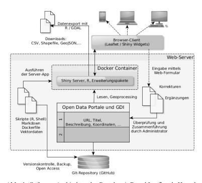
**Abb. 4:** Software-Architektur des Portals mit R und Leaflet als Hauptbestandteile
