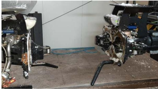
Abbildung 8: Linke DAK ist trotz nicht erfolgreichem mechanischen Kuppelvorgang in gekuppelter Stellung (Aufnahme 16.02.2021)
