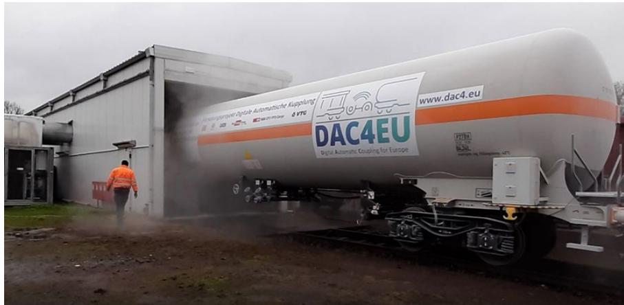
Abbildung 1: Z-Wagen bei der Einfahrt in die Klimakammer
