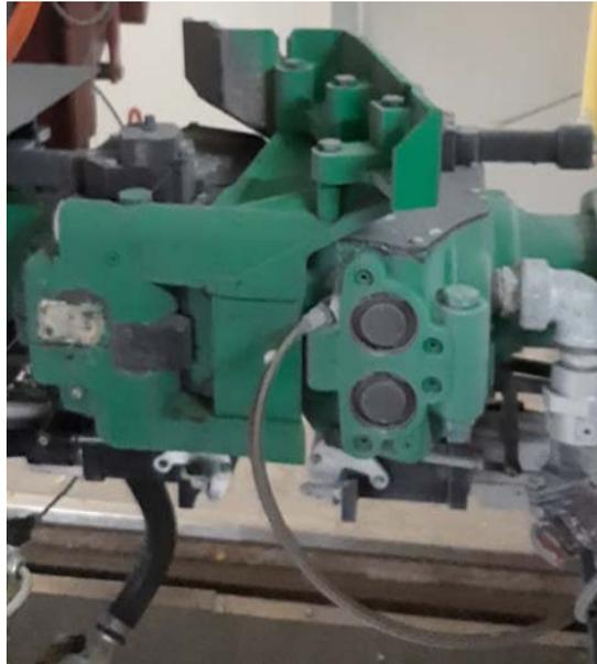
Abbildung 17: Unvollständiges Kuppeln, linker Kupplungskopf zeigt in Kuppelanzeige "3", rechter Kupplungskopf "1" (auf Bild nicht sichtbar, Aufnahme 10.05.2021)
