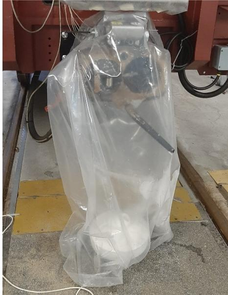
Abbildung 5: Erzeugung von 90 % Luftfeuchtigkeit bei +45° C im Bereich der DAK
