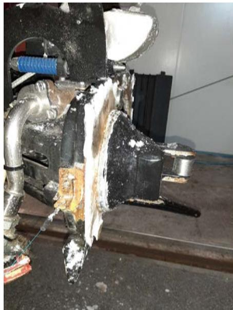
Abbildung 9: Detailaufnahme einer DAK im gekuppelten Zustand nach nicht erfolgreichem mechanischen Kuppelvorgang. Auf der Stirnfläche befindet sich stark komprimierter Schnee (Aufnahme 16.02.2021)
