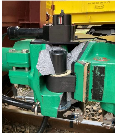
Abbildung 10: Gebrochene Kupplungsköpfe des Schwab-Designs
