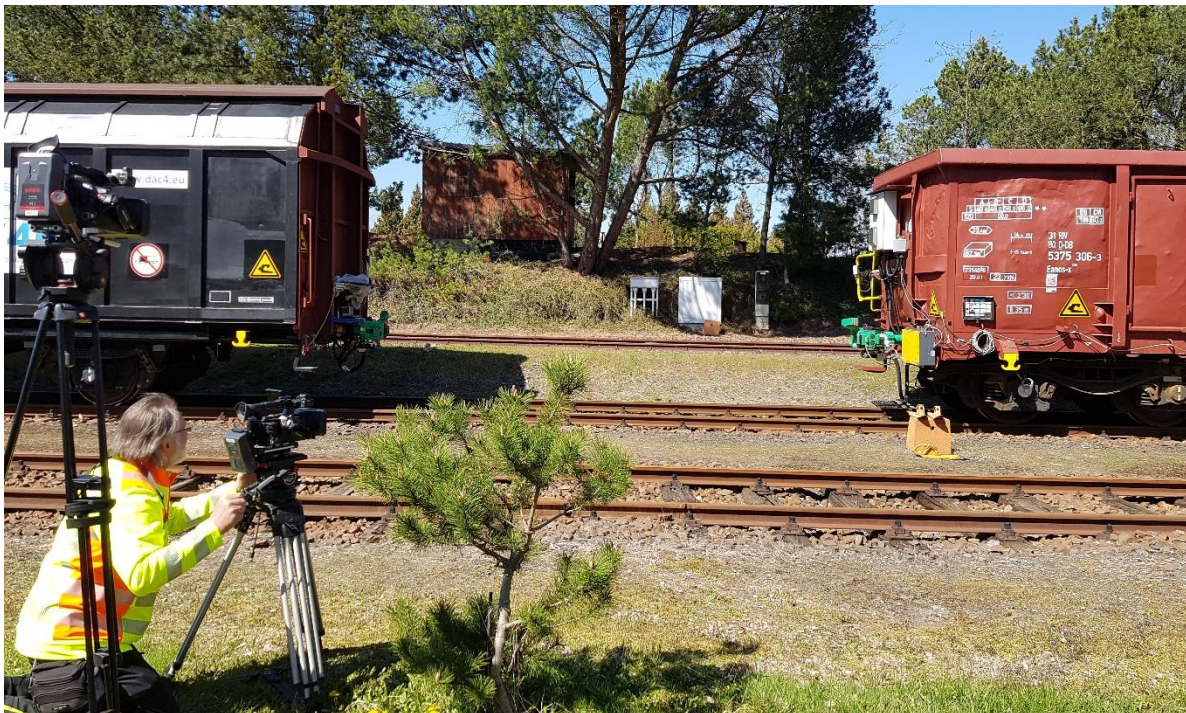
Abbildung 8: April 2021 - Kuppelversuche mit Schwab-DAK, kurz vor dem Kuppelstoß.
