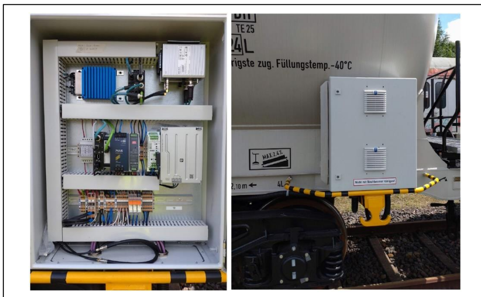
Abbildung 6: Beispiel Anschlussbox am Zags-Wagen
