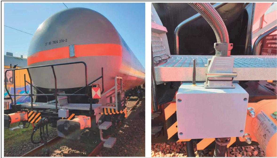
Abbildung 7: Kupplungsanschlussbox am Zugs-Wagen auf der Seite der Schraubenkupplung
