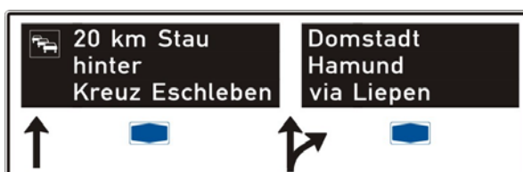
Abb. 2: Umlenkung mittels Zwischenziel
