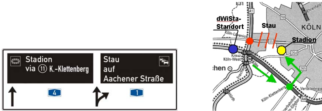
Abb. 9: Umlenkung aufgrund einer Störung im nachgeordneten Netz
