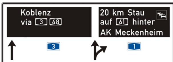
Abb. 8: Umlenkung aufgrund einer Störung auf entferntem BAB-Netzabschnitt
